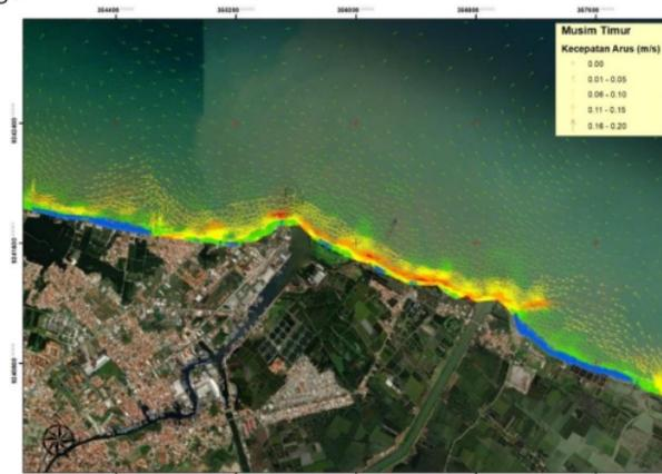
Gambar 5. Pola pergerakan arus susur pantai (*longshore current*) pada musim timur di Pesisir Kota Pekalongan
