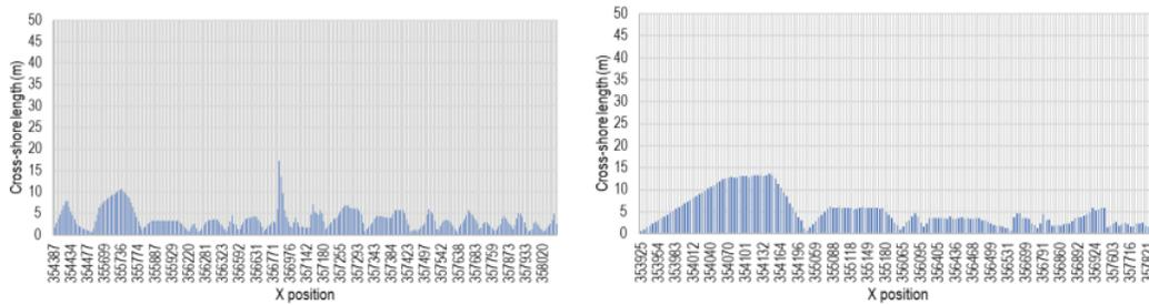
**Gambar 9.** Perubahan jarak garis pantai eksisting terhadap garis pantai hasil simulasi pada musim timur. Kondisi akresi ditunjukkan pada gambar kiri dan kondisi abrasi ditunjukkan pada gambar kanan.
