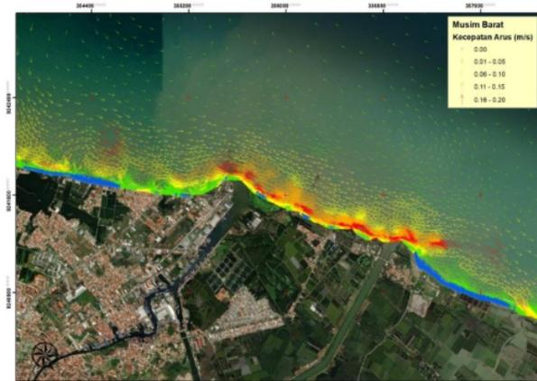
Gambar 4. Pola pergerakan arus susur pantai (*longshore current*) pada musim barat di Pesisir Kota Pekalongan
