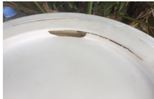
Gambar 6. Kondisi tutup tong yang pecah
