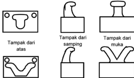
Gambar 35. Contoh Konstruksi Bollard
