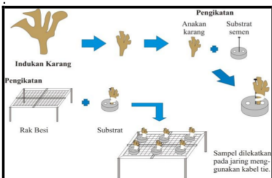
Gambar 2. Skema penempelan substrat pada rak
