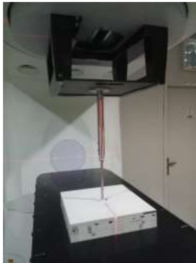
Gambar 8.1. Pengaturan nilai SSD pada jarak 100 cm dari kepala LINAC ke permukaan solid water phantom .
