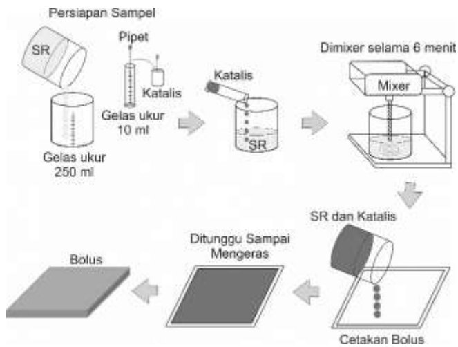
Gambar 7.1. Skema pembuatan bolus dengan bahan SR
