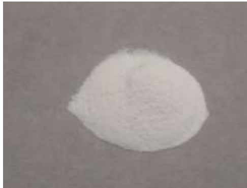
Gambar 10.1. Serbuk silika dengan kemurnian 75% yang berasal dari limbah geotermal pada pembangkit listrik tenaga panas bumi (PLTPB).
