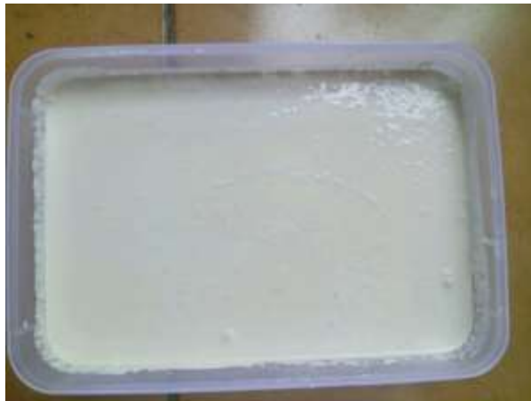
Gambar 7.3. Latex yang telah mengental di cetakan plastik
