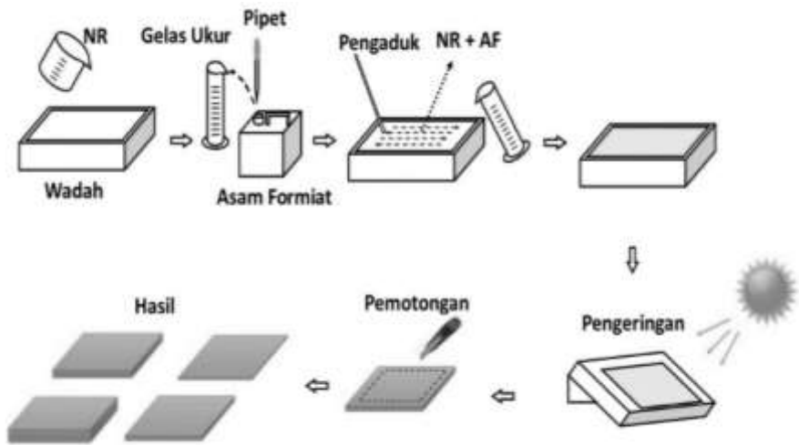
Gambar 7.5. Prosedur pembuatan bolus NR dari bahan latex .
