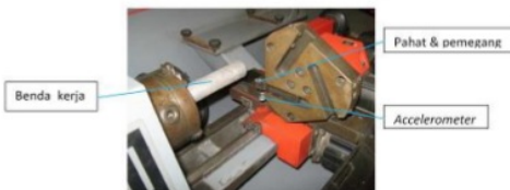
Gambar 2. Foto set up pengujian
