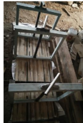
Gambar 4. Proses pengepresan papan bambu lapis
