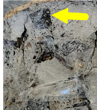
Gambar 7. Terlepasnya lekatan interfasa antara mortar dan agregat
