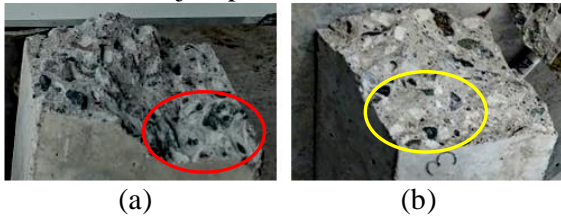
Gambar 11. Fraktur pada bidang keruntuhan tarik. (a) keruntuhan mortar dan interfasa, (b), agregat terlepas dari mortar.
