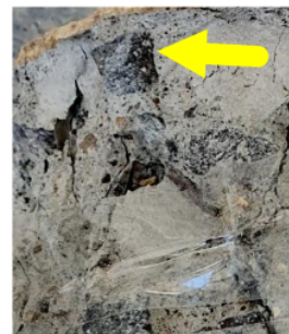
Gambar 7. Terlepasnya lekatan interfasa antara mortar dan agregat
