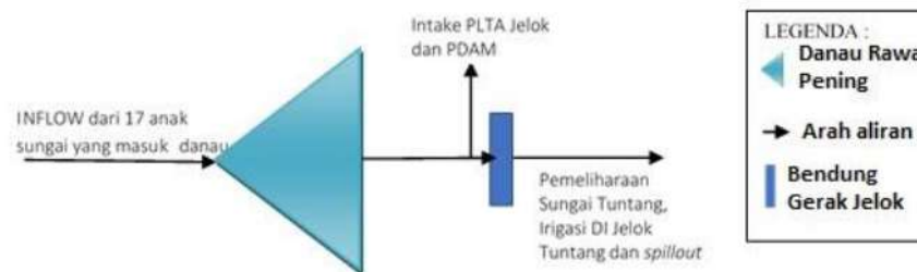
Gambar 6. Skema Sistem Waduk Rawa Pening
