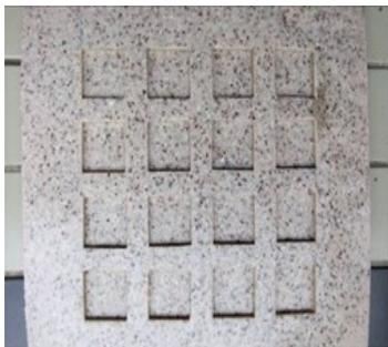
**Gambar. 3.15** SFRP dengan pola wafel untuk material akustik [13]
