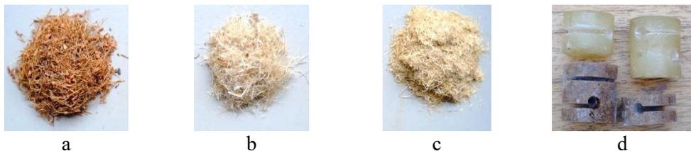
**Gambar 4.1.** Biomassa: (a) sabut kelapa, (b) hemp, (c) kenaf, dan (d) sampel material[28]
