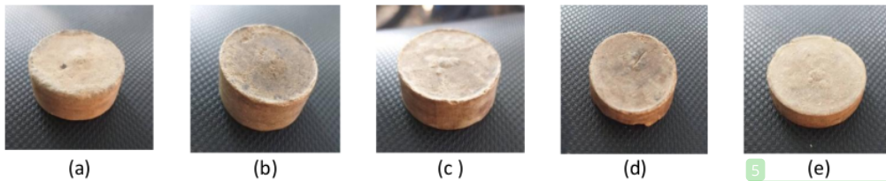
Gambar 1. Penampakan visual komposit dengan komposisi styrofoam :serbuk ijuk aren 10:90 (a); 20:80 (b); 30:70 (c); 40:60 (d); dan 50:50 (e).
