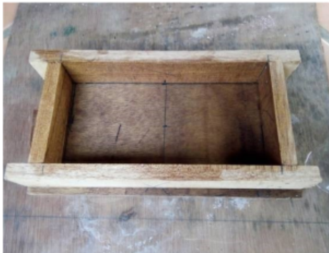
(1) Cetakan mortar cangkang kerang dan semen
