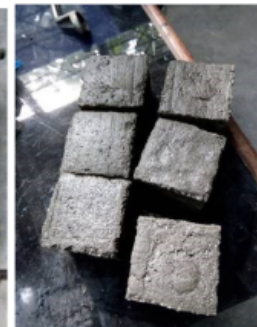
(4) Sample material yang siap diuji kuat tekan
