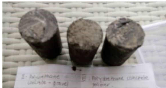
Gambar 2.9. Sampel Penelitian untuk Uji Akustik
