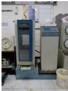
(5) Mesin Uji Kuat Tekan pada Laboratorium Bahan dan Konstruksi Departemen Teknik Sipil FT UNDIP
