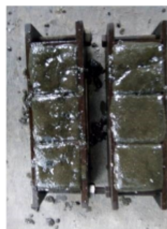
(4) Sample material yang siap diuji kuat tekan
