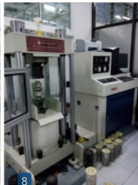
(5) Mesin Uji Kuat Tekan pada Laboratorium Bahan dan Konstruksi Departemen Teknik Sipil FT UNDIP
