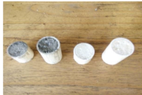
(2) Cetakan mortar cangkang kerang dan semen
