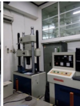
(5) Mesin Uji Kuat Tekan pada Laboratorium Bahan dan Konstruksi Departemen Teknik Sipil FT UNDIP
