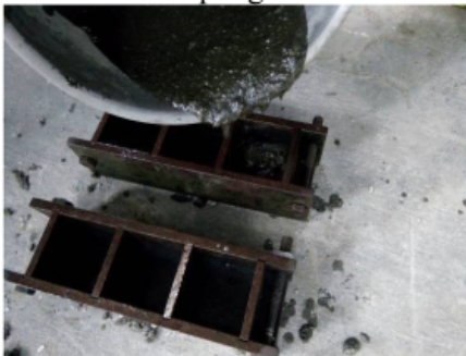
(3) Penuangan adukan pada cetakan beton
