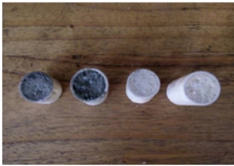
(1) Cetakan mortar cangkang kerang dan semen
