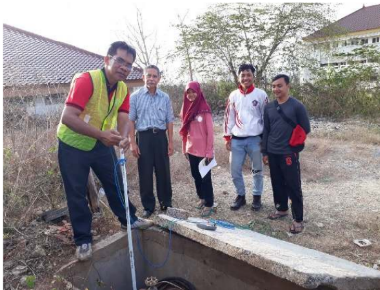
Gambar 5. Uji Sumur dengan Metode Step Drow Down Test
