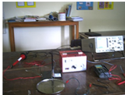
Gambar 2 Sistem pembangkit plasma
