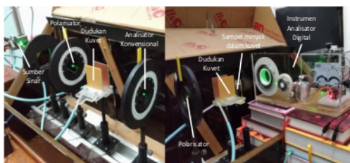
Gambar 3. Analisator Digital dalam Instrumen Polarimeter.
