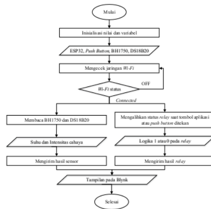
Gambar 5. Diagram alir pemrograman Arduino IDE.
