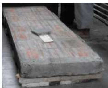
Gambar 2. keraton yang telah dirangkai menjadi pelat (Hazairin et al., 2013)
