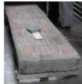
Gambar 2. Keraton yang telah dirangkai menjadi pelat (Hazairin dkk., 2013)
