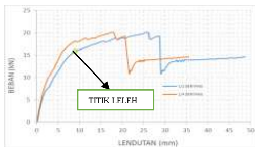
Gambar 11. Kurva Hubungan Beban dan Lendutan benda uji 2S
