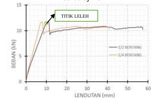
Gambar 12. Hubungan Beban dan Lendutan benda uji 4S
