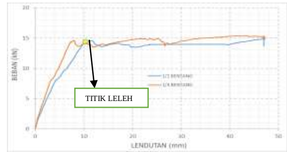
Gambar 12. Kurva Hubungan Beban dan Lendutan benda uji 4S
