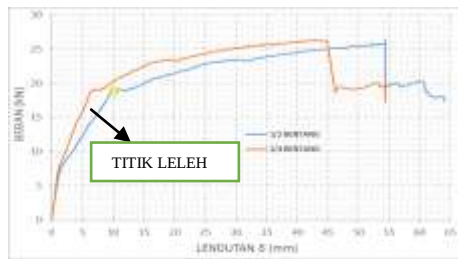
Gambar 9. Kurva Hubungan Beban dan Lendutan benda uji B
