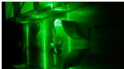
Gambar 7. Longitudinal vortex teramati pada aliran bagian belakang dari sepasang concave rectangular winglet vortex generator
