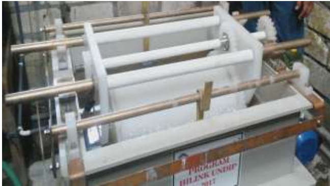
Gambar 4.2 Hasil Rancang Bangun Mesin Barrel Elektro-Plating
