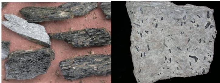
**Gambar 8.4.** Mineral hornblende pada andesit porfir (batuan beku intermediet)
