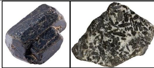
**Gambar 8.3.** Mineral piroksen berwarna hitam pada gabbro (batuan beku basa), berasosiasi dengan plagioklas berwarna putih
