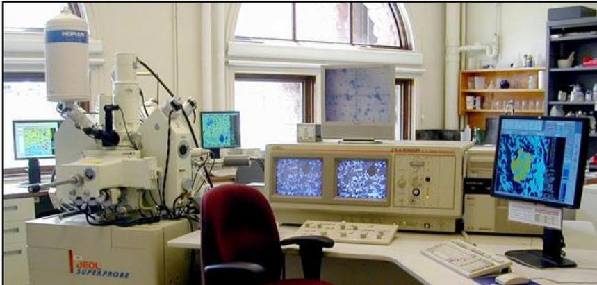
**Gambar 1.4.** Electron Probe Micro-Analyzer (EPMA), mampu mendeterminasi kimia mineral secara akurat dengan visualisasi beresolusi tinggi (Goodge, 2020)
