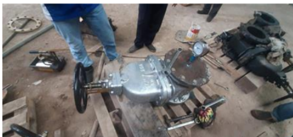
Gambar 2. Pengisian air pada valve yang diuji
