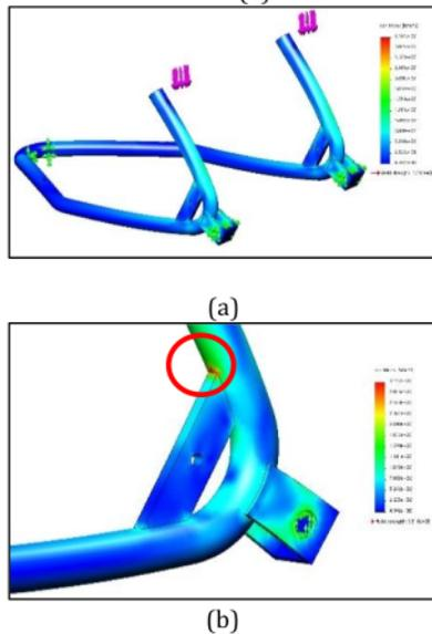
Gambar 7. Hasil Simulasi RIB dengan lubang (a) dan letak titik kritis (b)
