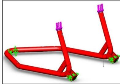
Gambar 4. Boundary Condition dari kerangka Paddock Stand
