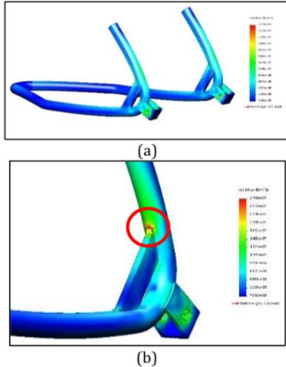
Gambar 6. Hasil Simulasi RIB (a) dan letak titik kritis (b)
