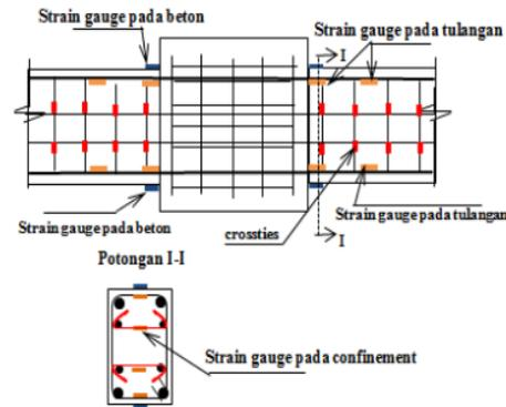
Gambar 3. Instrumentasi pada spesimen.
