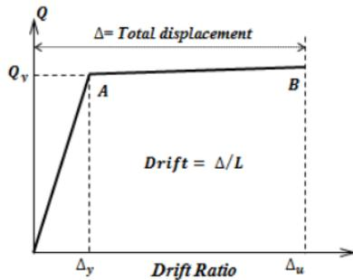
Gambar 5. Deformasi komponen (ACI 374.1-05)
