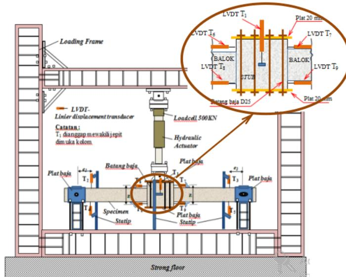
Gambar 4. Set up pengujian (Priastwi *et al.*, 2017)
