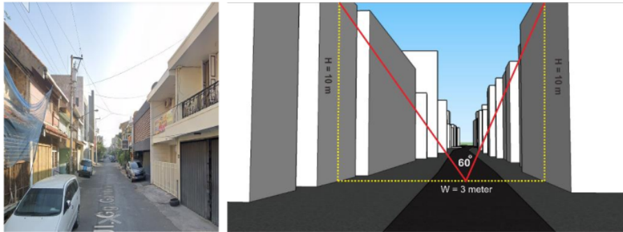
Gambar 1. Geometri Jalan Gang Gambiran Terhadap Bangunan
