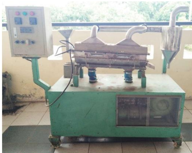
Gambar 3.4. Photo pengering unggun terfluidisasi kontinyu
