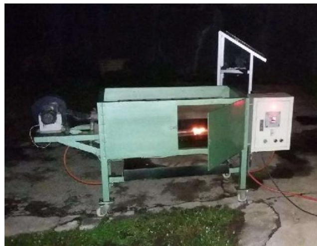
Gambar 3.6. Photo sistem pemanas udara menggunakan LPG
