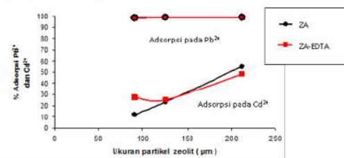
Gambar 3. Grafik hubungan persentase adsorpsi dengan ukuran partikel zeolit
