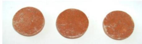
Gambar 2 Foto genteng glasir serbuk kaca/TiO<sub>2</sub> tipe pembakaran ganda (*double firing*)
