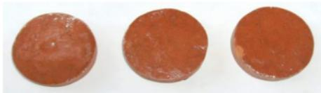
Gambar 1 Foto genteng glasir serbuk kaca/TiO<sub>2</sub> tipe pembakaran tunggal (*single firing*)
