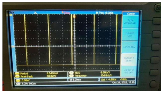
Gambar 11. Tampilan gelombang impuls dengan tegangan keluaran rata-rata 26,56 kV dan masukan 5 V
