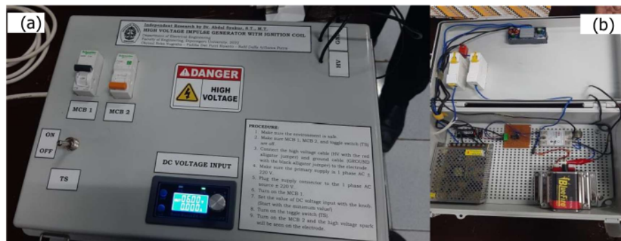
Gambar 5. Produk generator tegangan tinggi impuls 31,4 kV (a) Tampak atas dan (b) tampak dalam
