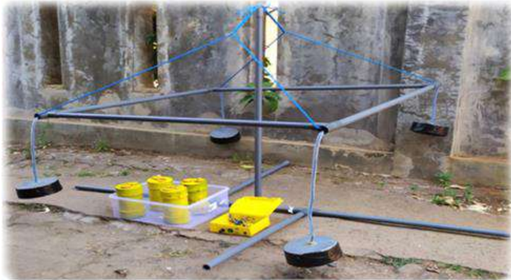
Gambar 14. Prototipe rumpon dengan kombinasi cahaya dan gelombang suara menggunakan sumber energi dari air laut
