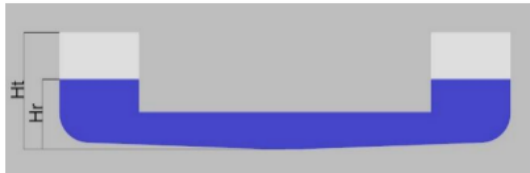
Gambar 1. Model 2D passive tank dengan ketinggian fluida Hr dan ketinggian tangki Ht
