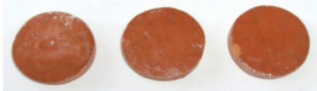
Gambar 1 Foto genteng glasir serbuk kaca/TiO 2 tipe pembakaran tunggal ( single firing )
