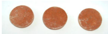
Gambar 2 Foto genteng glasir serbuk kaca/TiO 2 tipe pembakaran ganda ( double firing )
