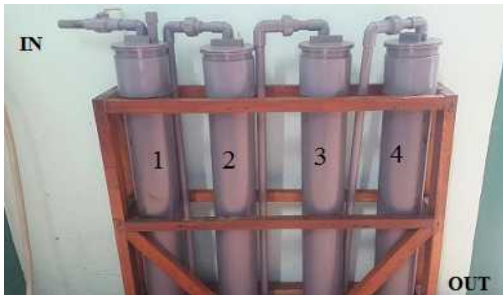
Gambar 3.1 Rangkaian alat penyaringan air artesis untuk RT 01 RW 01 Bulusan
