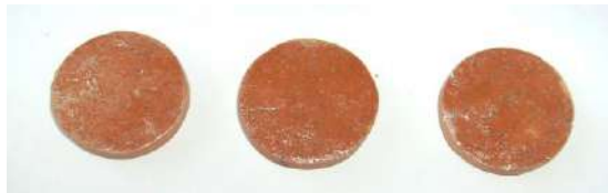
Gambar 2 Foto genteng glasir serbuk kaca/ \text{TiO}_2 tipe pembakaran ganda ( double firing )
