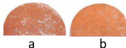
Gambar 3 Foto hasil genteng glasir .(a) pembakaran tunggal dan (b) pembakaran ganda
