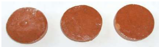
Gambar 1 Foto genteng glasir serbuk kaca/ \text{TiO}_2 tipe pembakaran tunggal ( single firing )
