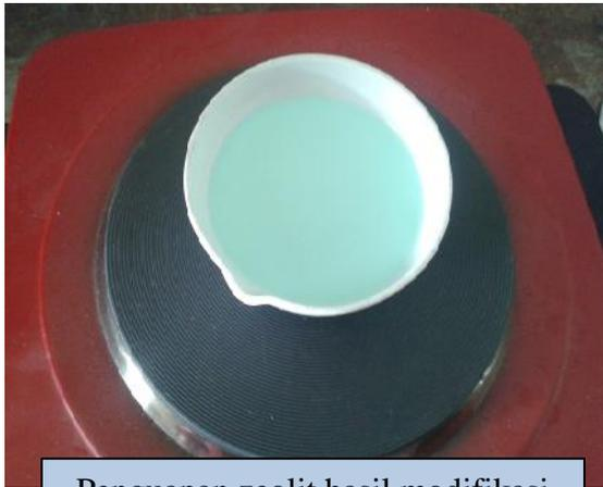
Penguapan zeolit hasil modifikasi  $\text{NiCl}_2$  menggunakan hot plate
