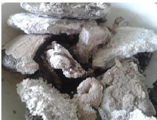
Gambar 5.2 Abu ampas tebu setelah diekstraksi dengan NaOH
