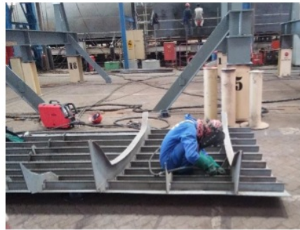
Gambar 1. Perakitan penguat dan pemasangan profil pada shell (Budi Utomo, 2018)
