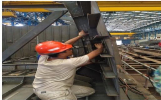
Gambar 5. Pemasangan alat bantu fairing (Budi Utomo, 2018)
