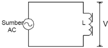
Gambar 7. Rangkaian Beban Induktif
