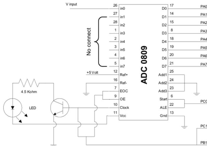
Gambar 3. Rangkaian pengubah sinyal analog ke digital
