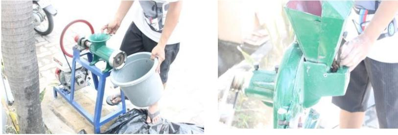
Ilustrasi 8. Mesin Peleting Tanaman air
