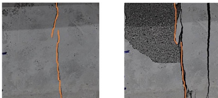
Gambar 4. Pola Retak Awal dan Akhir pada Benda Uji Kontrol
