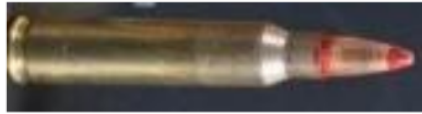
Gambar 4. Peluru atau munisi yang digunakan dalam simulasi elemen hingga dalam penelitian ini MU4-TJ [4].
