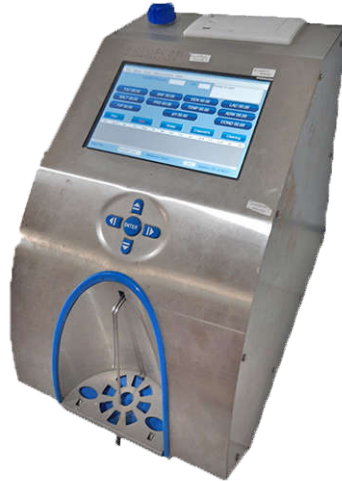
Gambar 18. Lactoscan untuk menganalisis kandungan kimiawi susu (Dokumentasi Lab. PTPP)
