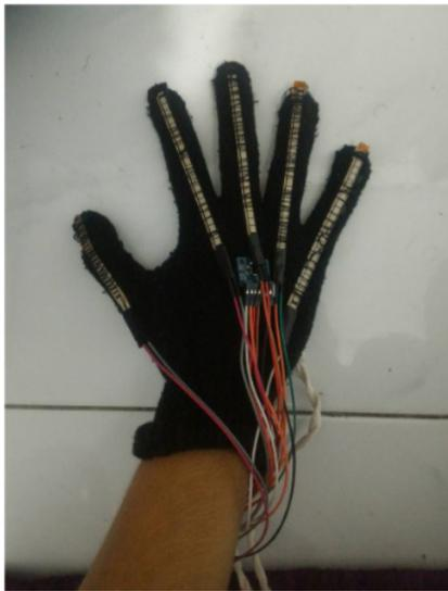
Gambar 2. Sarung tangan dengan sensor *flex* dan MPU-6050 dengan posisi jari lurus
