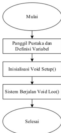
Gambar 3. Diagram alir perancangan perangkat lunak sistem sarung tangan *flex*
