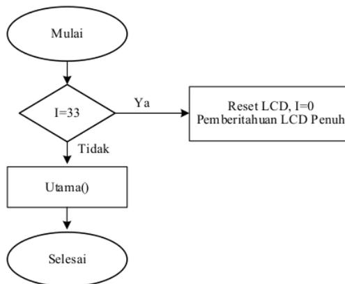
Gambar 5. Diagram alir void loop()
