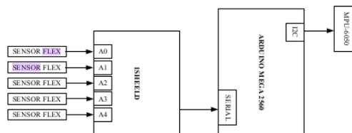
Gambar 1. Diagram blok perangkat keras sistem sarung tangan *flex*
