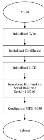
Gambar 4. Diagram alir void setup()
