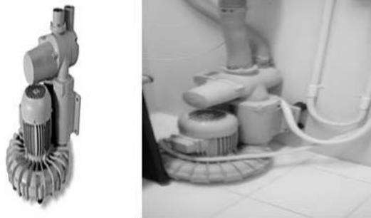
Gambar 7. *Blower* sebagai penggerak sirkulasi udara utama pada sistem *pneumatic*.
