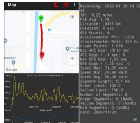
Gambar 3. Grafik dan nilai IRI rata-rata perkerasan pracetak
