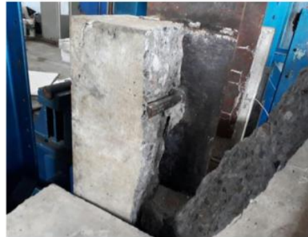
Gambar 7. Beton terbelah memanjang pada posisi shear connector
