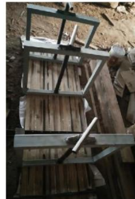
Gambar 4. Proses pengepresan papan bambu lapis
