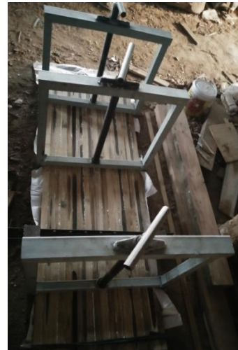
Gambar 4. Proses pengepresan papan bambu lapis
