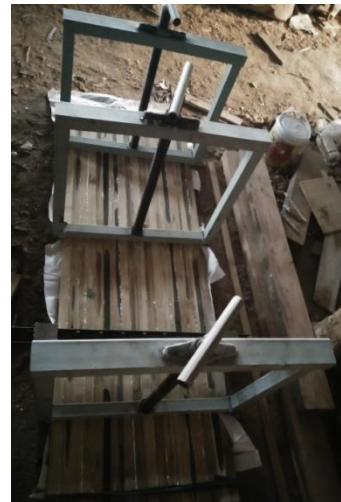
Gambar 4. Proses pengepresan papan bambu lapis
