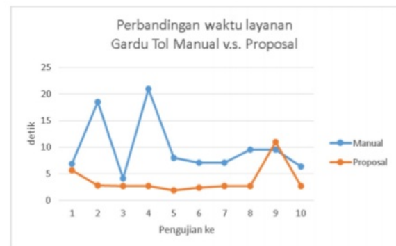
Gambar 12. Grafik perbandingan antara waktu layanan di Gardu Tol secara manual dan identifikasi berbasis RFID yang diusulkan.
