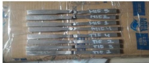
Gambar 11. Spesimen setelah pengujian
