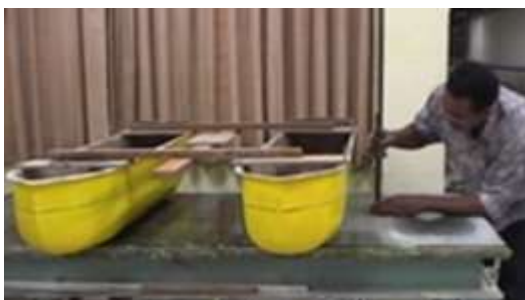
Gambar 12. Model Uji Tahanan Kapal
